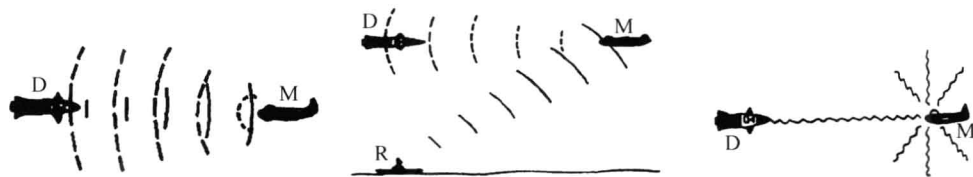
图 1-3 自动寻的方式 D—导弹;M—目标;R—照射雷达。
