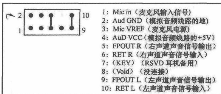
图 1-9 主板音频跳线中英对照说明
