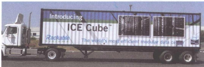
c) 运输中的集装箱数据中心
