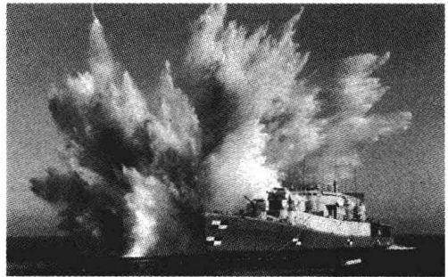
图 1.4 意大利海上实船爆炸试验
