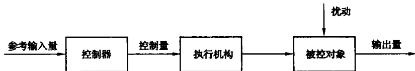
图 1-4 开环控制系统原理框图
