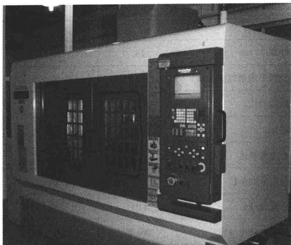
图 1-4 VTC-200B 型四轴（A 轴）立式加工中心
