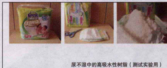
尿不湿中的高吸水性树脂（测试实验用）
