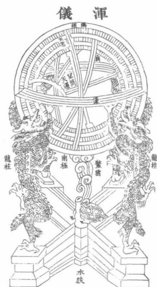
"Hun Yi" (Esfera armilar), uno de los instrumentos importantes de observación astronómica en la antigua China. Sirve para definir las posiciones de los cuerpos celestes. Este dibujo muestra un "Hun Yi" fabricado por Su Song, científico de la dinastía Song
