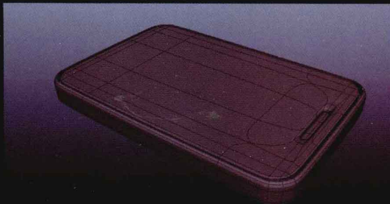
➤ iPhone手机的制作：使用多边形建模方式，注意开槽等细节，参见6.3节
