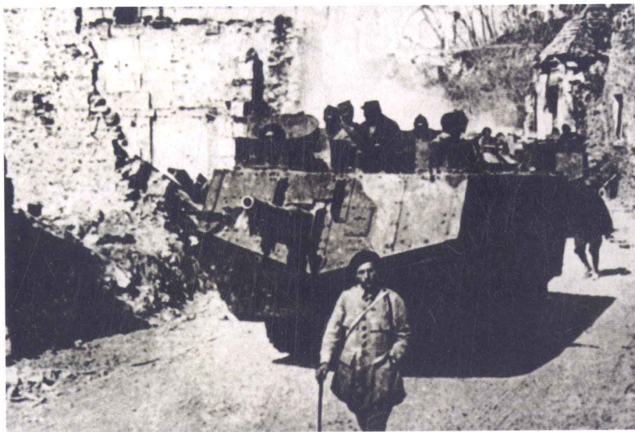
法国“圣沙蒙”突击坦克，1916年装备法军。战斗全重23吨，乘员8人。车体似船形，前置1门75毫米榴弹炮，另有4挺机枪。
