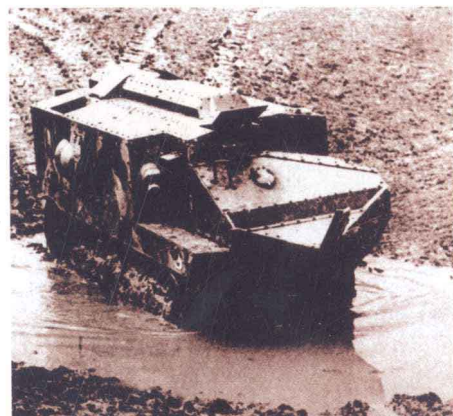
法国“施耐德”突击坦克,1916年装备法军。共生产400余辆,第一次世界大战后退役。战斗全重14.6吨,乘员6人,有1门75毫米榴弹炮,两侧各有1挺机枪。
