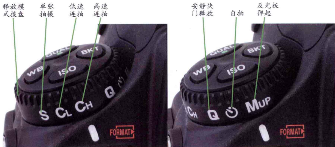
图1-1 按下释放模式拨盘锁定解除按钮，然后旋转拨盘即可选择某种释放模式。
