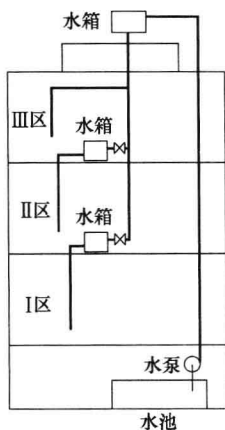
图 1-13 设减压水箱的给水方式
