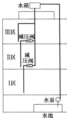
图 1-14 设水箱减压阀的给水方式
