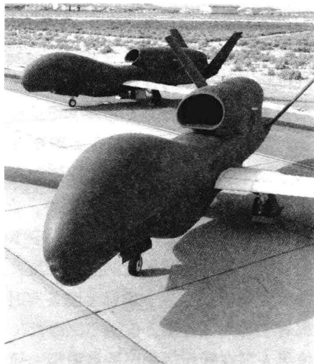
RQ-4“全球鹰”战略无人侦察机是目前最先进的高空长航时飞行器，由于航程较远，它在飞行途中需要卫星数据链来中继传输获取的信息，其卫星天线配置于机首上方隆起的整流罩内。（诺斯罗普·格鲁曼公司）
