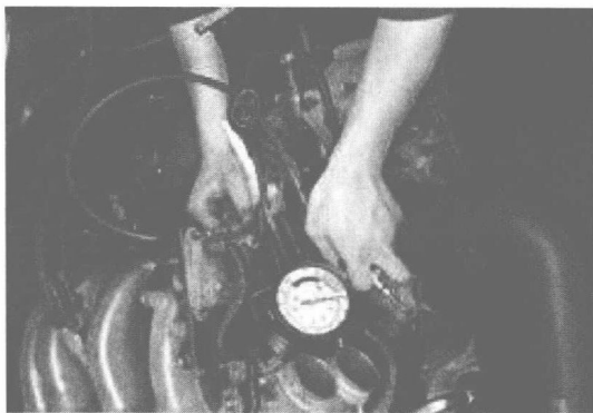
图 1-2-1 燃油压力检测
