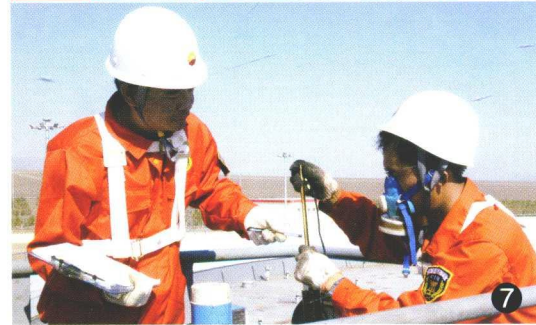
⑤⑥⑦⑧ 2006年7月25日,阿拉山口出入境检验检疫局石油科检验计量人员正在对中哈管道进口原油岸罐计量测油泥、检尺、测温、取样。
