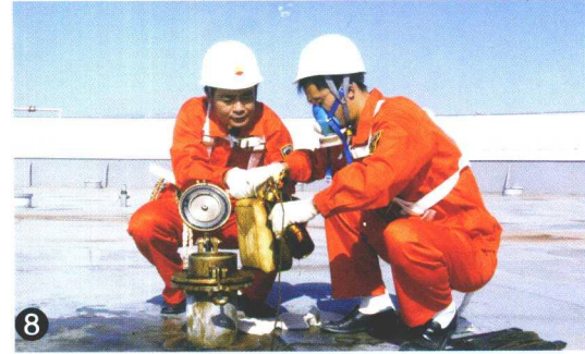
⑤⑥⑦⑧ 2006年7月25日,阿拉山口出入境检验检疫局石油科检验计量人员正在对中哈管道进口原油岸罐计量测油泥、检尺、测温、取样。
