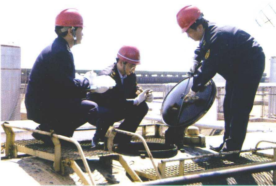
阿拉山口出入境检验检疫局石油科检验计量人员正在进行油罐检尺。
