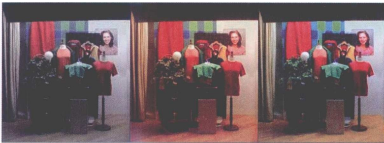
图 3-13 左图: 冷白光荧光灯, 4100K, CRI 60; 中图: 白炽灯, 2800K, CRI 100; 右图: Reveal® 白炽灯, 2800K, CRI 78 (来源: http://www.gelighting.com/eu/resources/learn_about_light/pop_color_booth.html )
