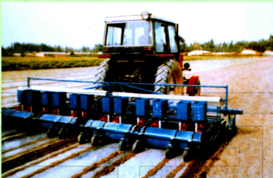
▲20 世纪 90 年代中农一师 16 团研制的超宽膜半精量铺膜播种机。
