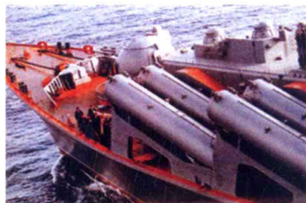
光荣级导弹巡洋舰装备的SS-N-12反舰导弹发射装置。
