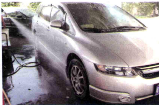
(d) 用清水冲洗车轮挡泥板内侧凹缘处，必要时用抹布或板刷清洗
