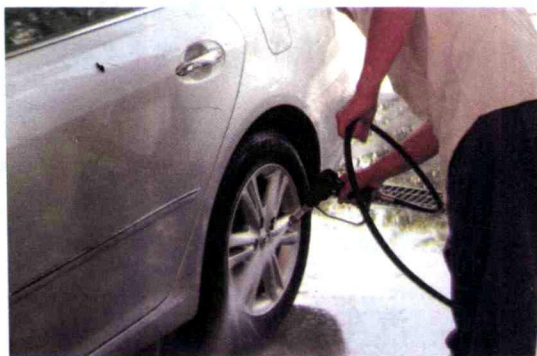
(f) 用清水冲洗轮胎及轮辐，再用软毛刷配合清除轮胎灰尘和脏物
