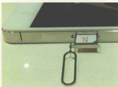
⑤ 将SIM卡托盘插回iPhone 4S侧边即可完成安装SIM卡
