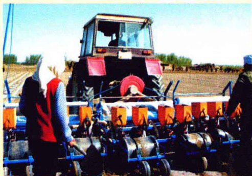
▶ 气吸式精量机械播种。
