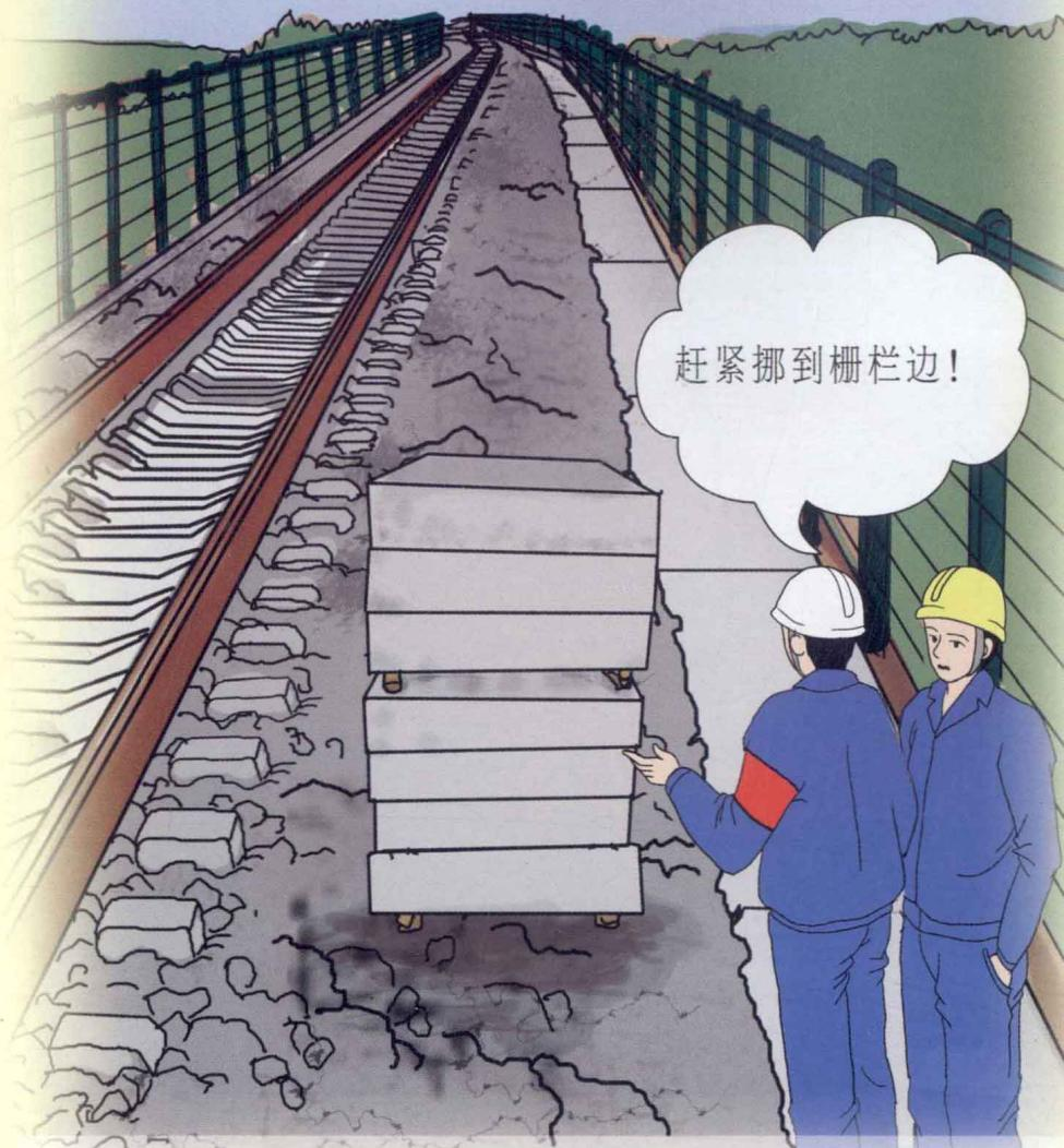
5. 靠近线路存放的材料，严禁侵入规定的铁路限界。道砟、片石、砂子等材料每次卸车后，施工负责人应组织人员全面检查存放情况，不符合规定或存放不稳固的应立即清理。
