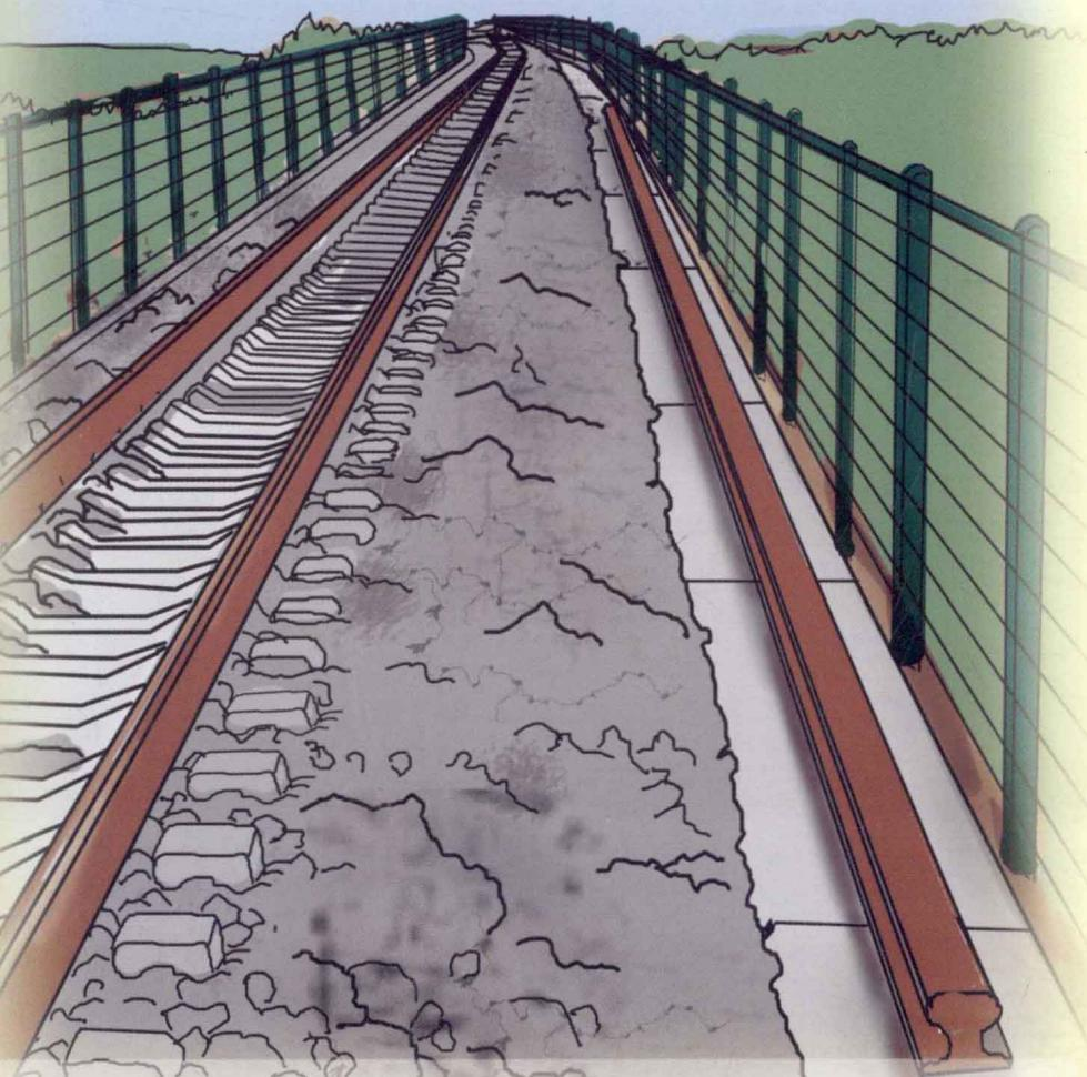
4. 营业线施工存放在线路外侧的钢轨，轨枕，组装的道岔，供电、通信、信号的电杆，未安装完的电缆箱盒等半成品，必须放置平稳，严禁侵入规定的铁路限界，必要时应采取加固措施。
