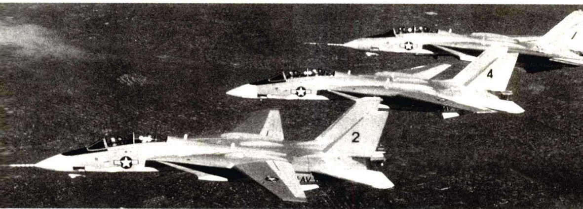
■比翼齐飞的“雄猫”02号、04号和01X号样机（由前至后），每架飞机的机翼后掠角各不相同
