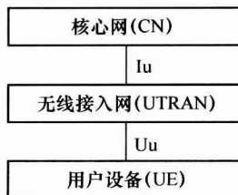
图 1.2 TD-SCDMA 系统结构图
