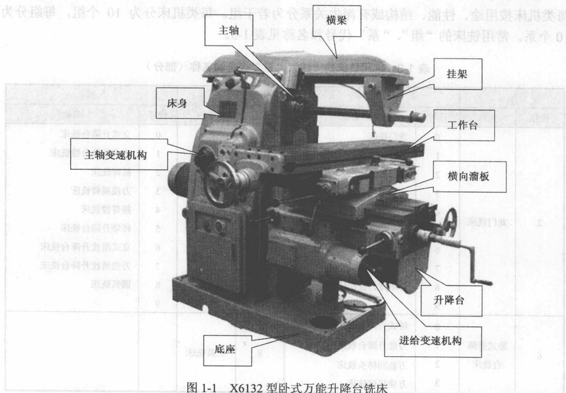
图 1-1 X6132 型卧式万能升降台铣床
