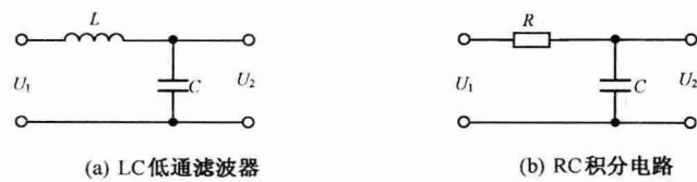
图 1.3.1 抑制传导噪声的滤波电路
