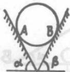
1.1-3 重  $P$  的球靠在与水平成  $\alpha$  及  $\beta$  角的两光滑固定面上之  $A, B$  点, 求  $A, B$  点的反作用力。
