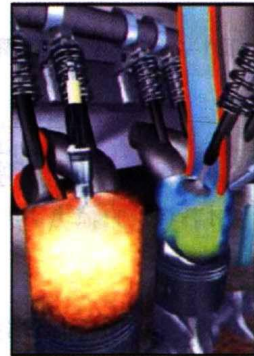
图1-20 发动机气缸内部点火瞬间
