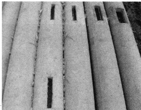
图1-1 缺陷管桩的制作
