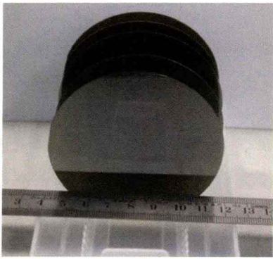
图9 中国科学院上海硅酸盐研究所碳化硅晶体项目部采用PVT法生长的直径为76.2mm的导电型4H-SiC晶片
