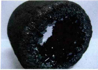
图2 20世纪60年代中国科学院上海硅酸盐研究所采用 Lely 法在石墨坩埚内壁上制得的 6H-SiC 晶片，其直径为 3~4mm
