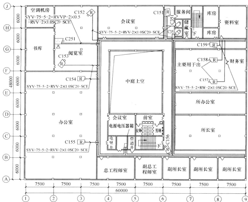
图 1-6 某科研楼视频监控系统 5 层平面图
