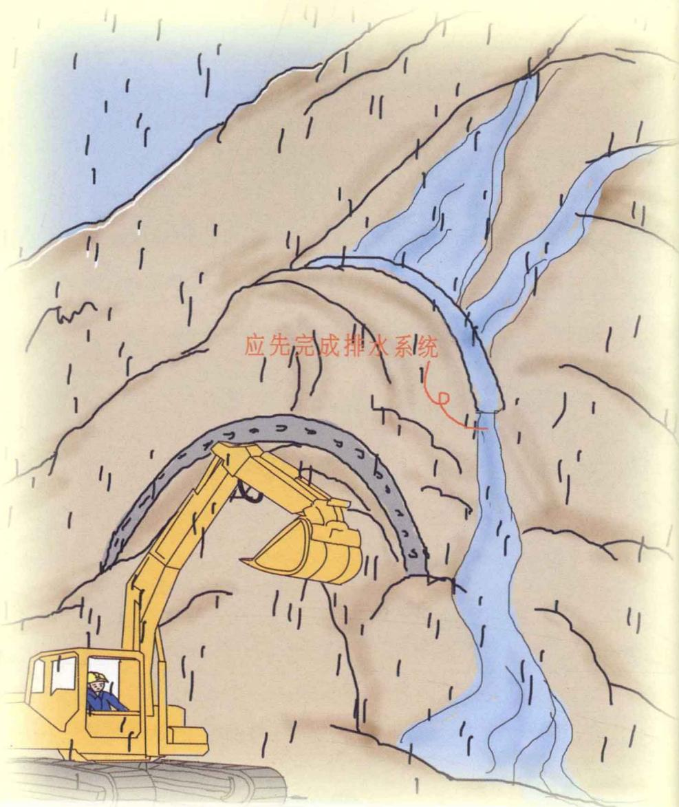
洞口边、仰坡上方的天沟应及时施作。对土质天沟应随挖随砌，不使水冲刷坡面。
