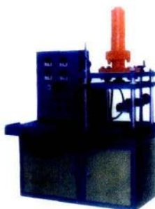
MYLMD6-60 × 60 卧式单工位高压液 压蜡模压注机
