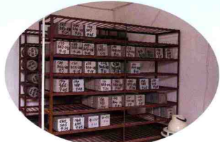
混凝土制品自然养护室
