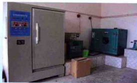
标准恒温恒湿养护箱(左)恒温干燥箱(右)
