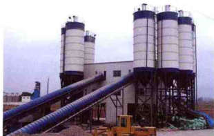
自动化主料配送塔
