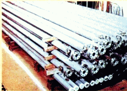
生產的合金爐管
