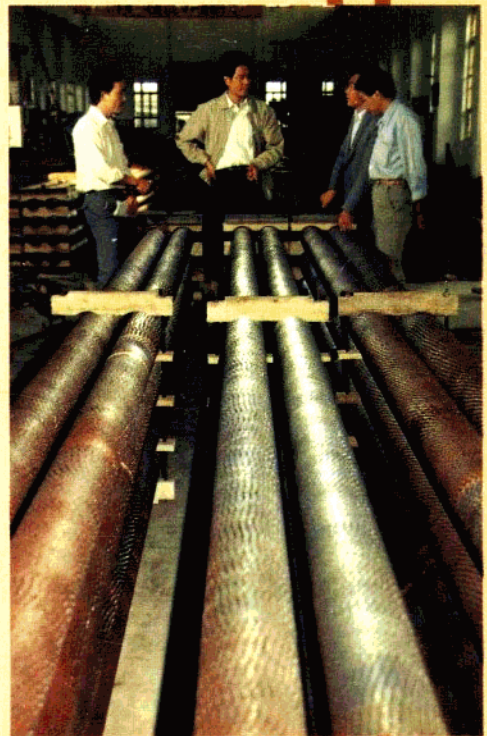
生產的高頻電阻焊接翅片管產品
