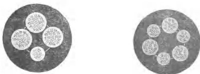
标号 ГРШС及ГРШСН六芯电缆的尺寸和重量
