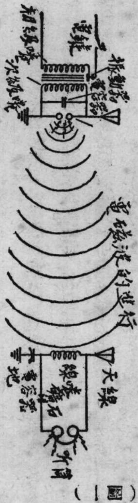
四面進行一樣。由這種發射機產生的電波，（電波爲電磁波的簡稱）叫做減幅波，因爲波幅（即波的闊度）是逐漸減小的，可用作無線電發報機，
