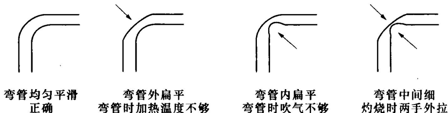
图 10-2-4 弯管成型比较
