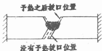
图6 附加热应力 \Delta\sigma_{热}^T 产生的示意图
