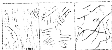
图 1—2 结晶与无定形高聚物的分子结构示意图
