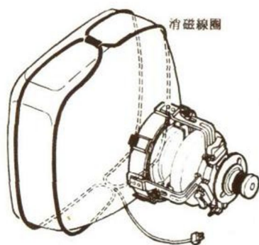
圖 1-2 映像管及消磁線圈
