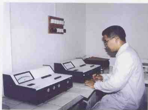
▲市环保监测站工作人员正在使用 721 分光光度计检测样本
