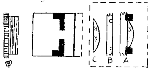
图五——① （注：甲图后二图下应加乙丙二字） 的上端接合，场镜片镶嵌在镜框上，镜框由丝牙与目镜筒的下端接合，或场镜片先放入镜筒下端后再由圈形螺丝固定如图中丙——A。
