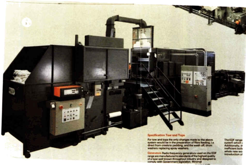
图 1 — Smith Dyefast (EDF) 的散纤维连续染色和干燥设备
