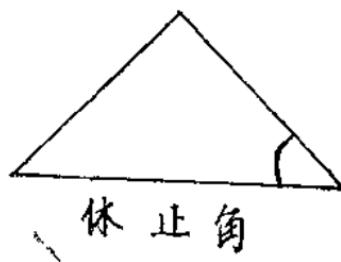
休止角的大小决定货物的流动特性，如果散货装仓后没有平仓，在海上一旦遇上风浪，船体摇摆剧烈，仓内货物就会移动，从而使船舶倾斜，以致倾覆。在海运史上曾发生过不少这样的惨痛事故。
