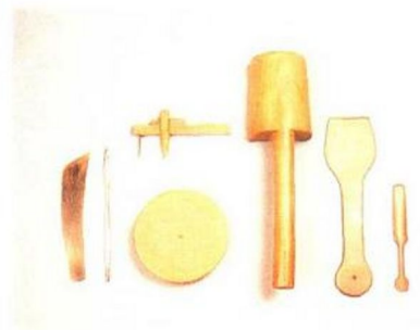
圖六：製作紫砂壺所用的工具，左起：明針、旁皮刀、規車(上)、木轉輪(下)、木搭子、木拍子、及小木拍子。
