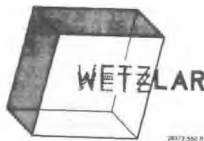
图9:方解石解理晶片的双折射
