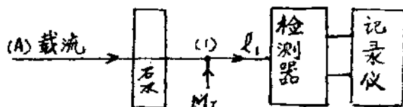
图2. FIPSA滴定曲线实验框图
