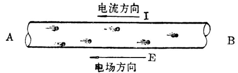
图1—3 在电场力的作用下，自由电子的有规则的定向运动形成了电流
