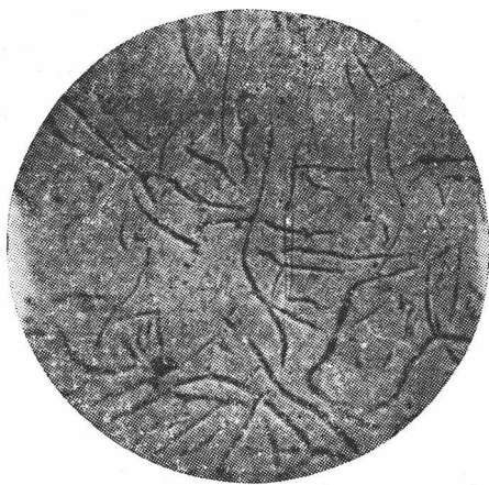
图3 改进前铸件的石墨形状， \times 100 。
